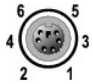
Figura B-4. Números de pata de los conectores para teclado y ratón compatibles con PS/2
